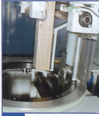
Gruppo pinza e taglio Clamp and cutting unit Folienarrätungs- und Folienabschnittsaggregat
