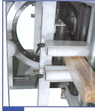
Pressori superiori e guide verticali Top pressure and vertical side guide units Andruckvorrichtung und Vertikalführungen
