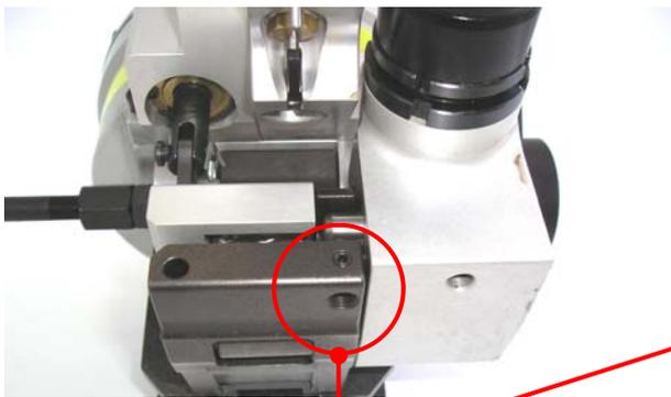
**VITE DI REGOLAZIONE DELLA DISTANZA TRA RULLO DI TRASCINAMENTO E RULLINO DI CONTRASTO**
