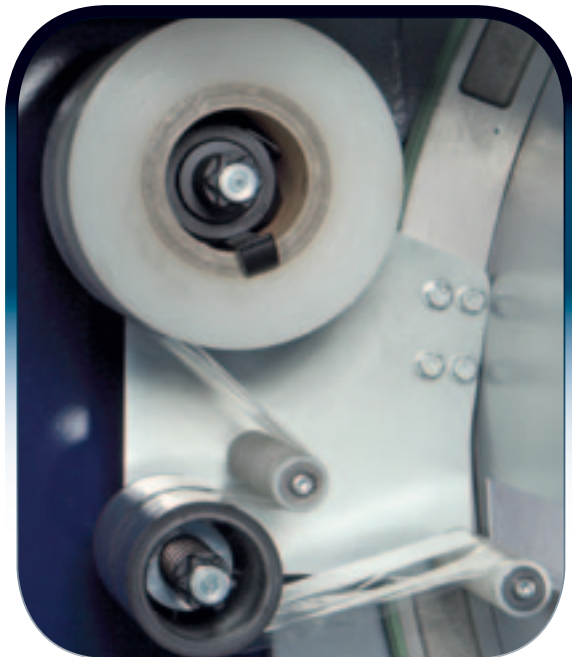
Mandrino con sistema anti-sgancio della bobina. Sostituzione della bobina senza l'impiego di utensili. Spindle with anti reel release system. Tool-less reel replacement
